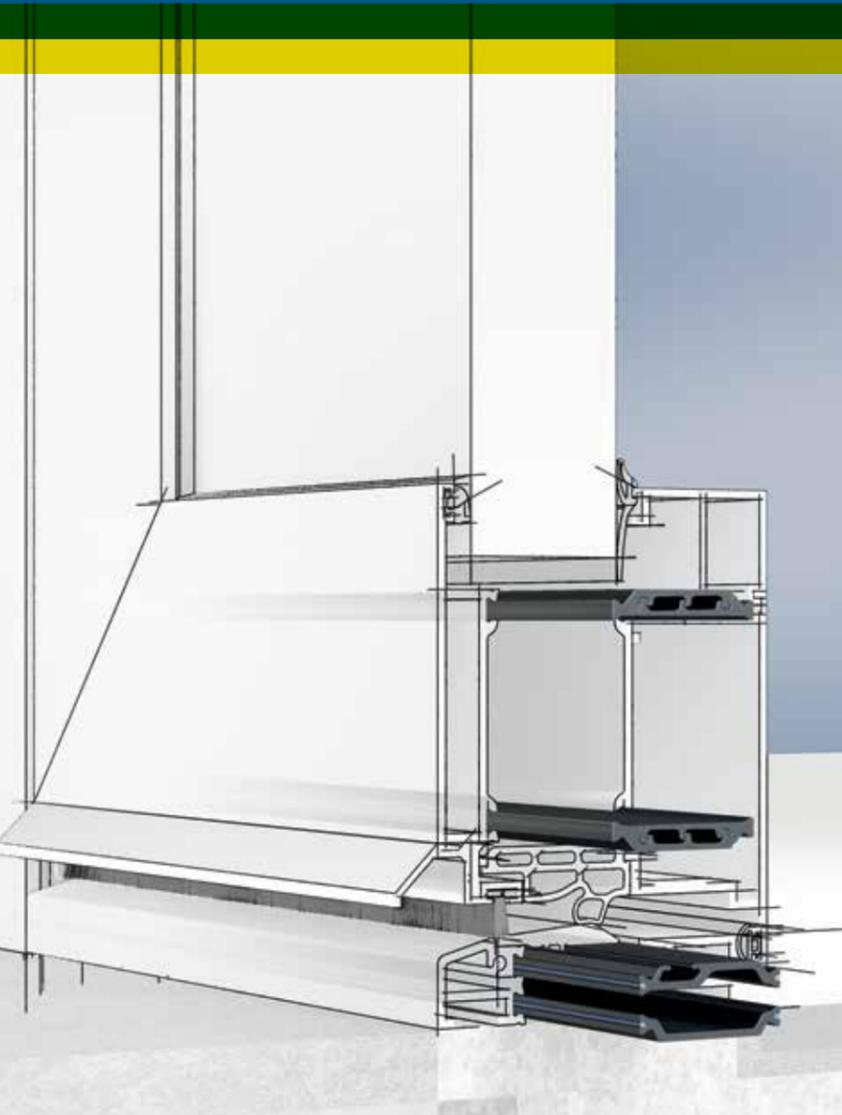
Para garantizar una intersección sencilla con simetría reflectiva, suministramos los perfiles sin cizallamiento en la forma adecuada: la mitad de los perfiles ya se encuentran girados en la jaula. Dos remaches de colores diferentes marcan claramente el sentido de giro de los perfiles de plástico.
