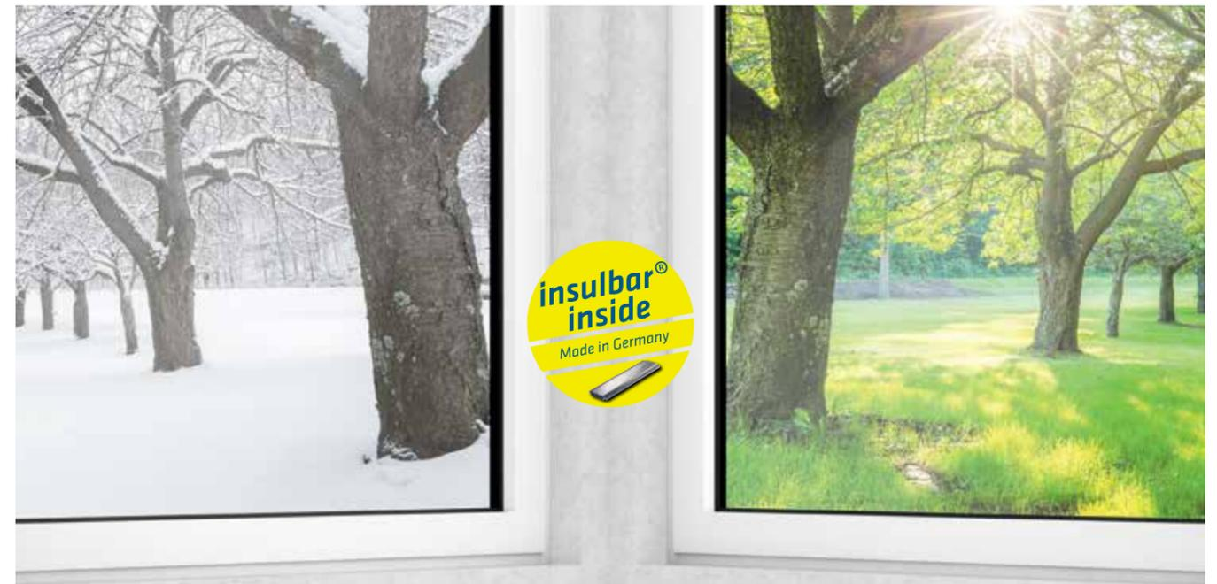
*Los sistemas de aluminio son resistentes a la intemperie, ligeros pero estables y, al mismo tiempo, grandes conductores térmicos. Los perfiles aislantes de plástico insulbar minimizan esta pérdida de calor, y por lo tanto garantizan coeficientes U especialmente bajos. De esta forma se reduce el consumo energético y, con ello, los costes de calefacción y refrigeración.*
