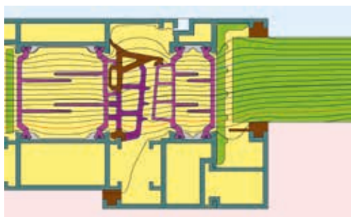
Coefficiente U_f = 1,3 \text{ W/m}^2\text{K} : sistema de ventana con profundidad de construcción = 73 mm y insulbar REG
