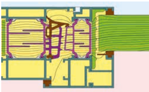
U_f -Wert = 1,3 W/m 2 K: Fenstersystem mit Bautiefe = 73 mm und insulbar REG
