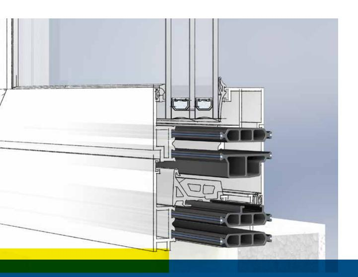
insulbar® Isolierprofil mit Low-E-Folie – die einfache Alternative zum Schaum
